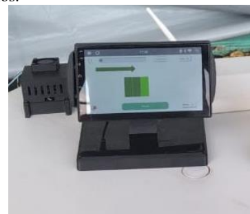
Figura 4 Sistema de aquisição de dados via WI-FI
