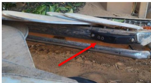
Figura 3 Instalação de sensoriamento abaixo dos recolhedores.
