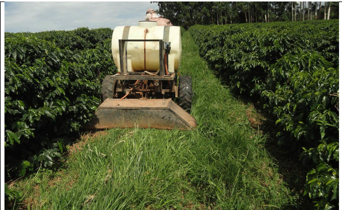
Vista de trás do triciclo operando com barra aplicadora de herbicida. No detalhe, pode-se observar a passagem bem rente aos cafeeiros e a barra bem próxima ao chão, com boa proteção, evitando deriva.
