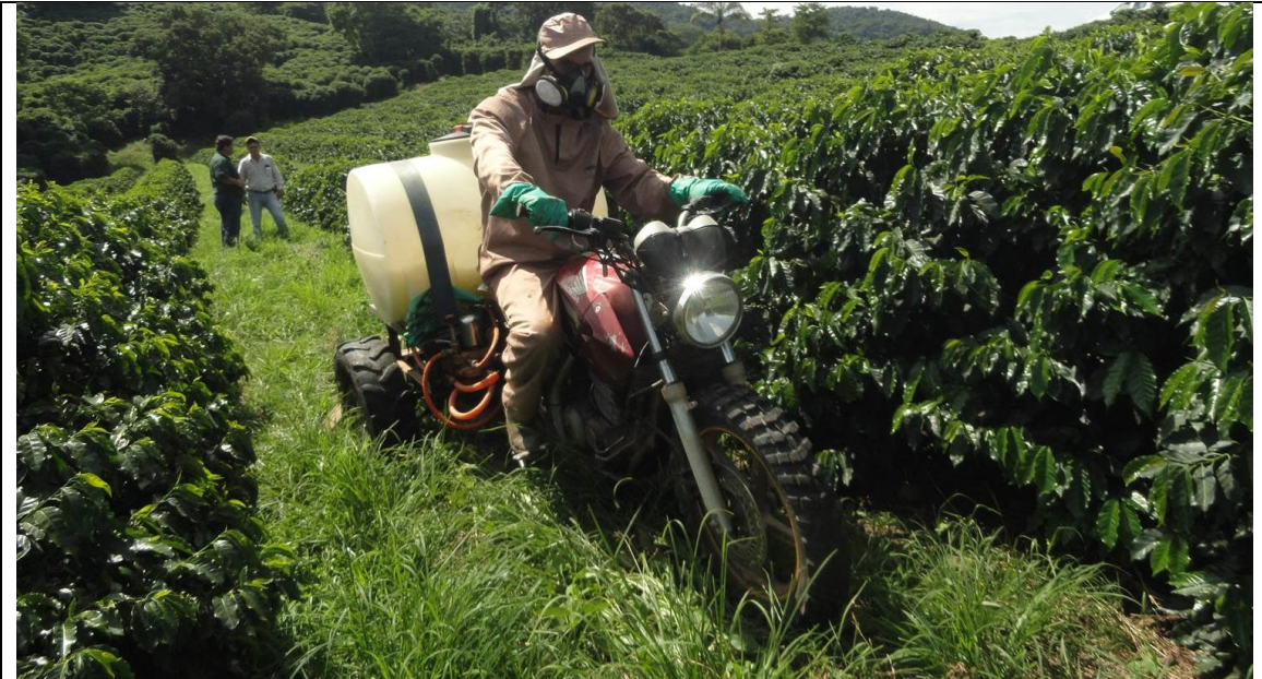
Triciclo operando na aplicação de herbicidas, vista de frente, o operador, por sua proximidade, tem boa visão do trabalho.
