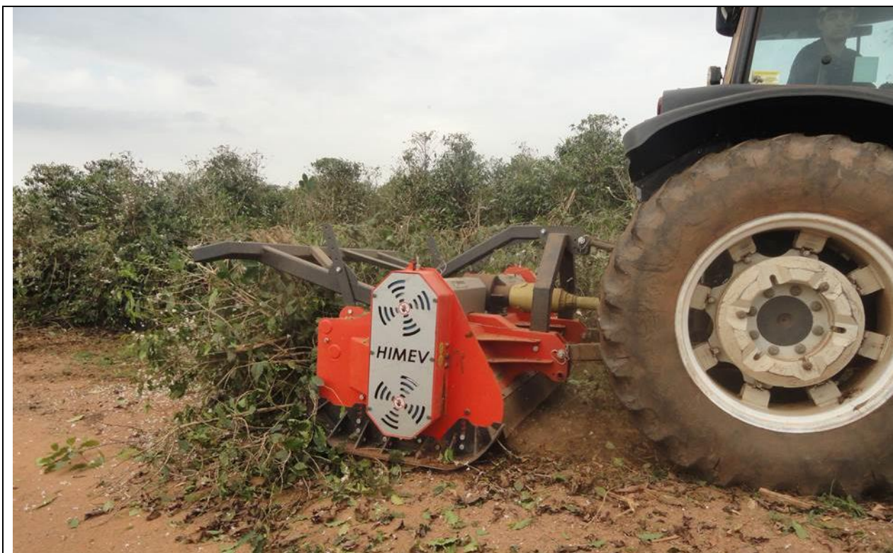
Detalhe da trincha especial Ecotritus, com o trator operando em ré, triturando o pé de café.
