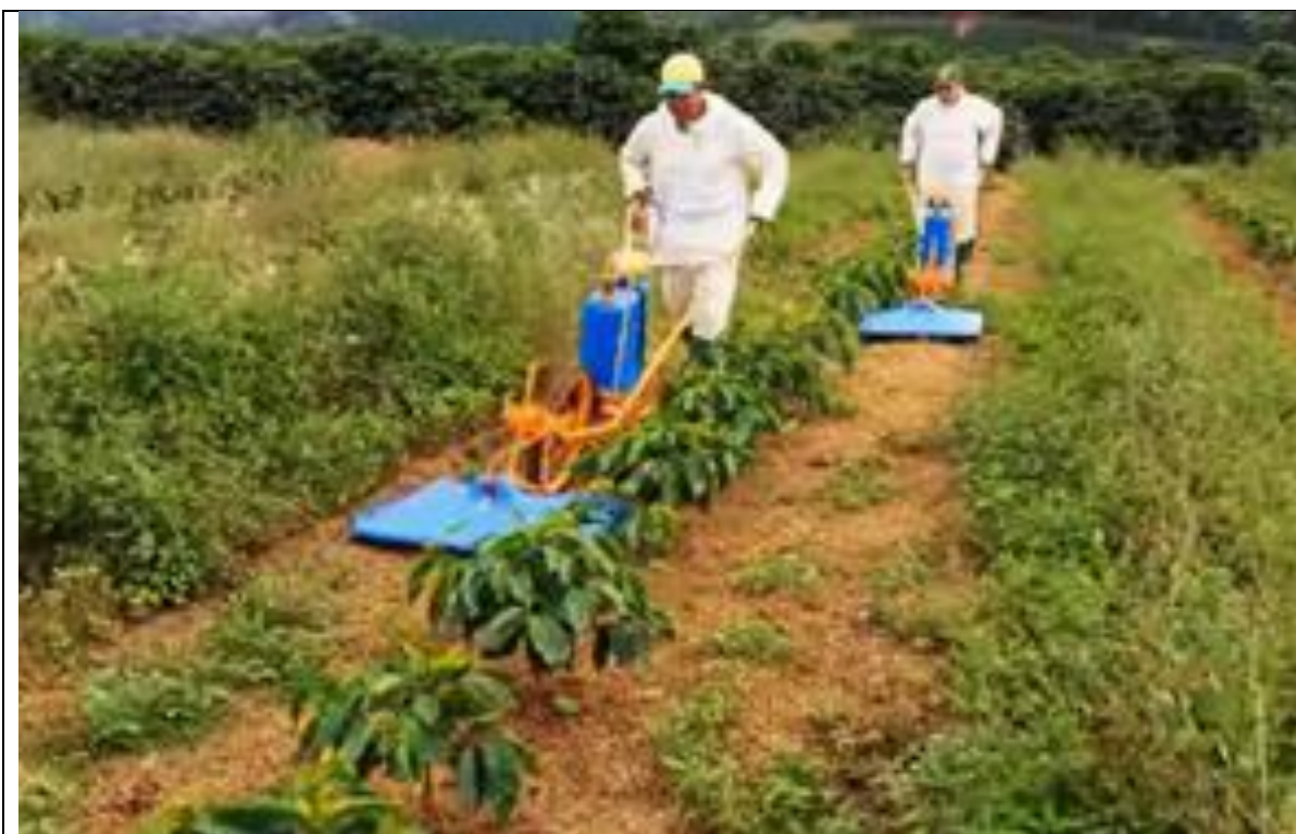
Carrinho aplicador, com barra frontal bem protegida, evitando deriva e fito-toxidez.
