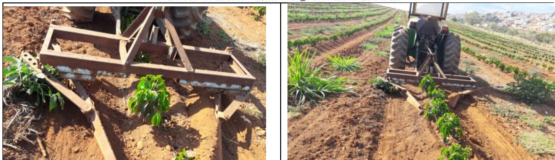
Fotos 1 e 2- Detalhe e geral do sistema operacional, mecanizado, para chegada de terra no tronco de cafeeiros jovens.
