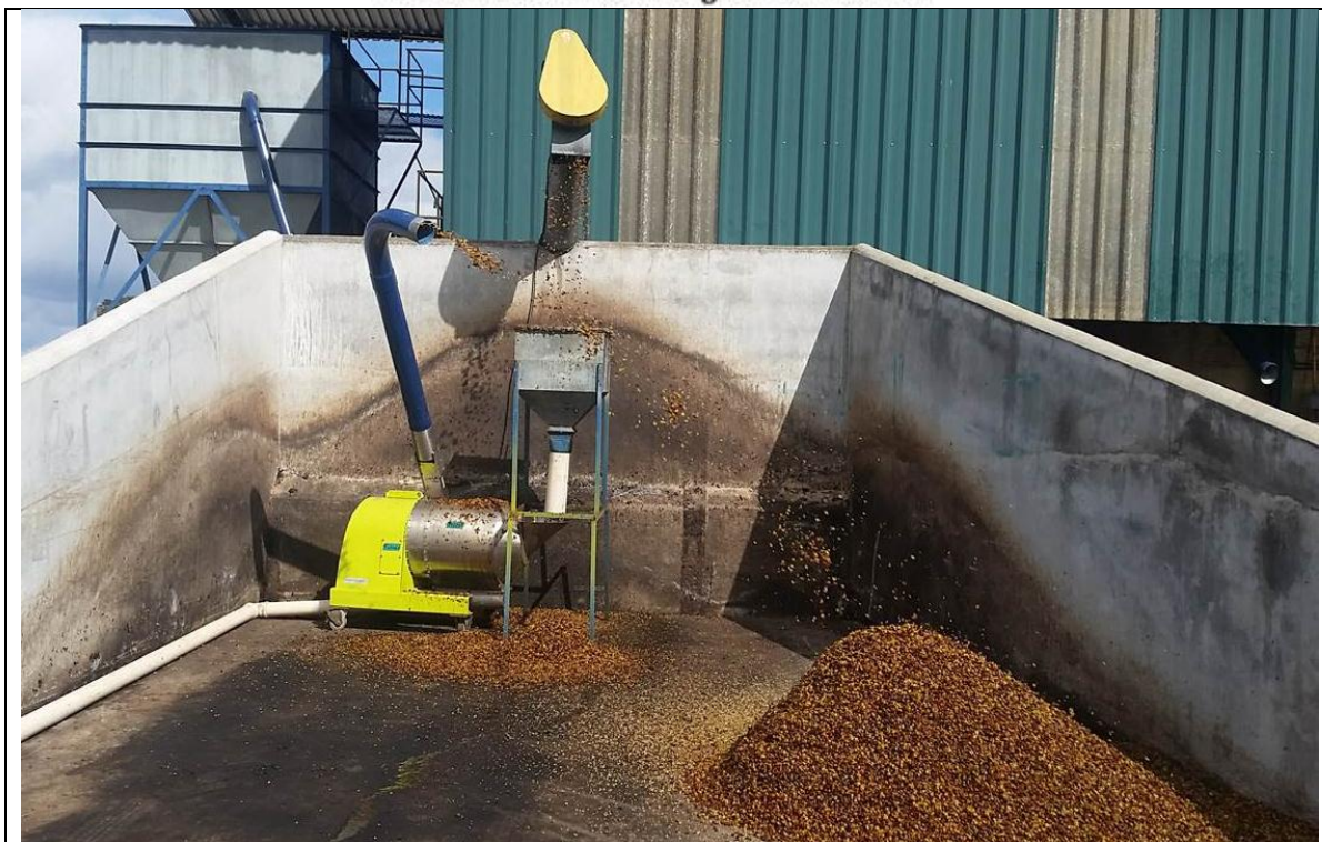
Centriflux modelo Filter, instalada sob a saída da casca do café despulpado, na Fda Sta Helena.
