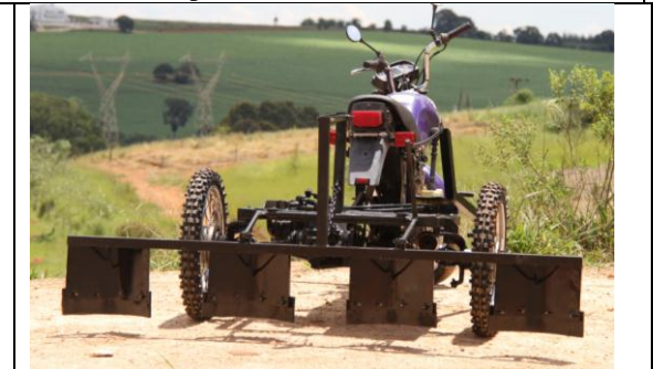
Moto-triciclo com equipamento roçadeira(esq.) e adubadeira calcareadeira ou esparrama tudo(dir.).
