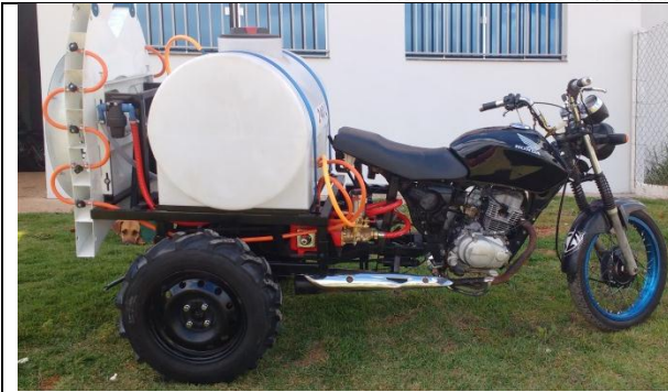
Moto-triciclo com equipamento de pulverização turbo(esq.) e pulverizador de barras verticais, este com barra aplicadora de herbicida, móvel, na traseira(dir.).
