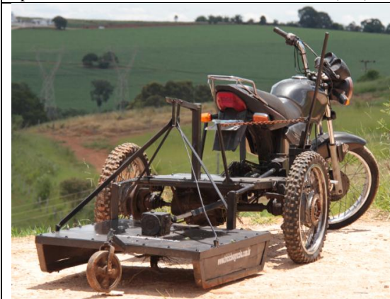
Moto-triciclo com equipamento roçadeira(esq.) e adubadeira calcareadeira ou esparrama tudo(dir.).
