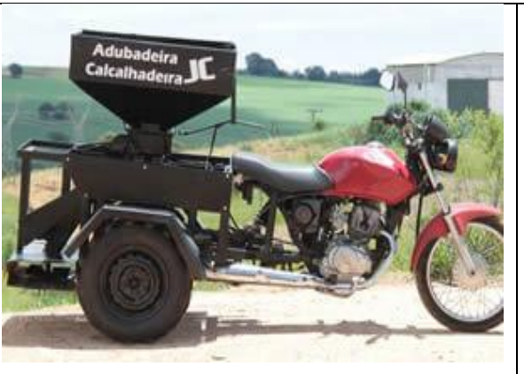
Moto-triciclo com equipamento roçadeira(esq.) e adubadeira calcareadeira ou esparrama tudo(dir.).
