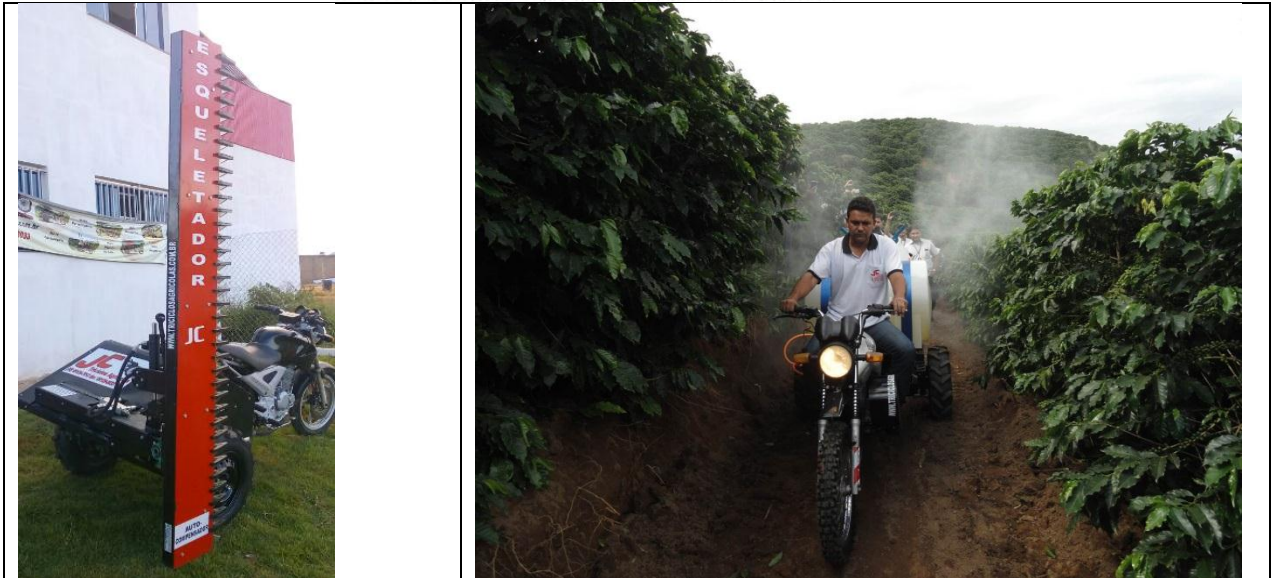
Moto-triciclo com esqueletadeira(esq.) e moto-triciclo em demonstração aplicando defensivos em pulverização, andando sobre micro-terraços, na Zona da Mata MG..
