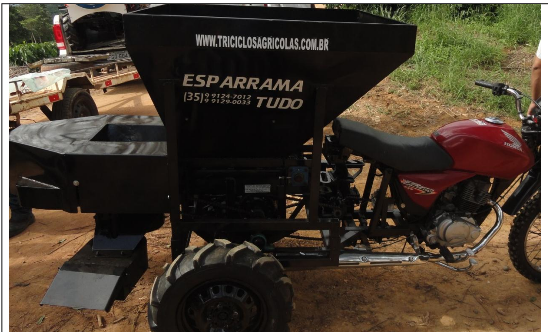
A aplicadora/esparramadora de produtos, como adubo químico, calcário e outros, chamada pelo fabricante de “esparrama tudo”, tem capacidade de até 400 kg(8 sacas de adubo), lançando lateralmente, para colocar o produto junto à saia, na linha de cafeeiros.
