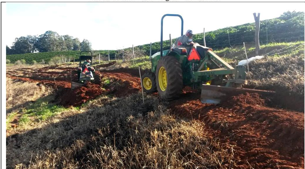
Os dois tratores trabalhando na abertura de micro-terraços, com lamina traseira, operando em área antes do plantio do café, no espaçamento de 3 m entre-linhas.
